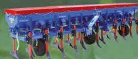
CULTIVADOR 12 HILERAS CON DOSIFICADOR DE QUÍMICO
